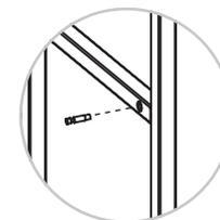
Posicionar os pinos minifix **B** nas estruturas metálicas.
